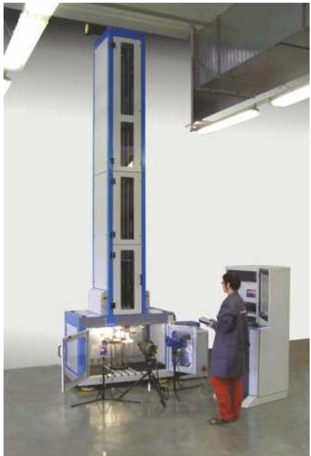
Fallhammer, max. Energie 3000 J, max. Geschwindigkeit 25 m/s
