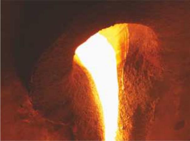
**Gießen von Formgussteilen** im Vakuumofen bis 50 l (Stahl, Nickelbasislegierungen usw.).
