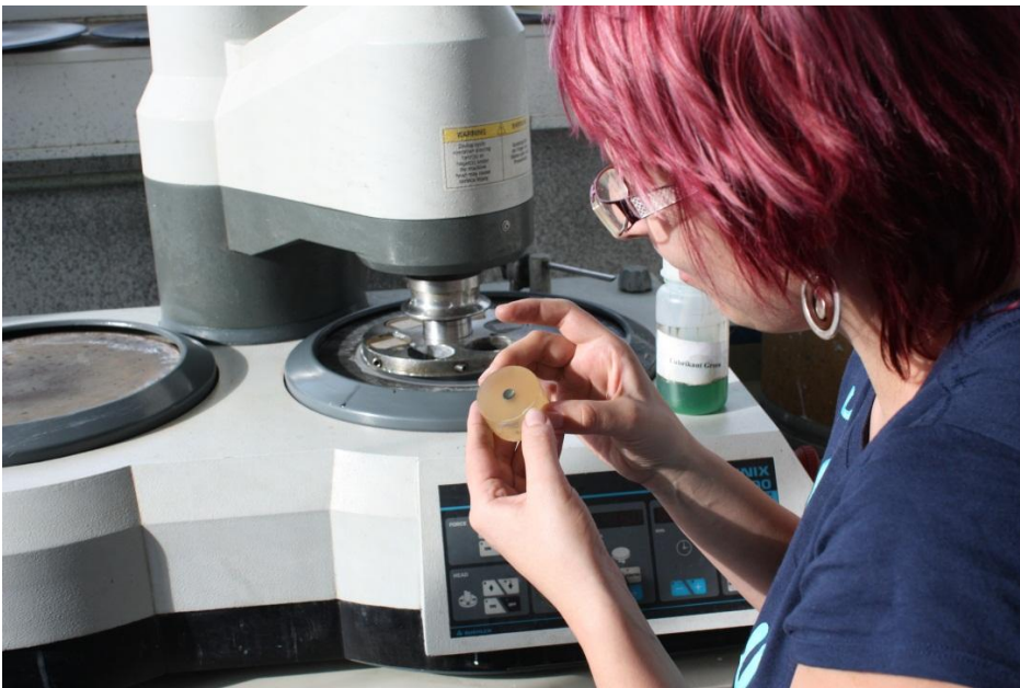
Obr.2 Příprava vzorků pro materiálové analýzy v centru aplikovaného výzkumu ZMMC
