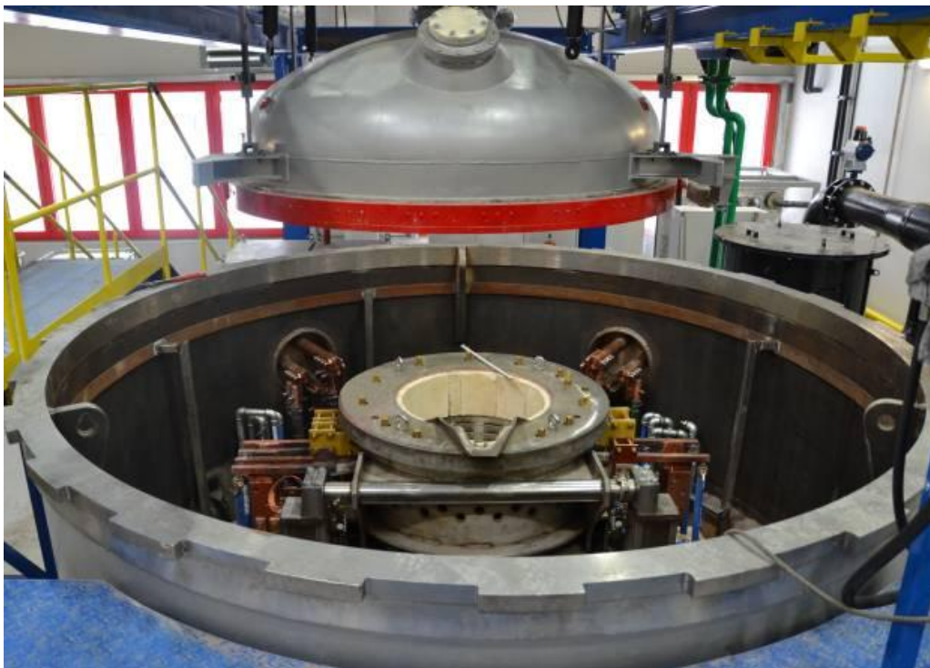
Obr.3 Metalurgická laboratoř centra je vybavena vakuovou pecí pro odlévání ingotů z experimentálních materiálů
