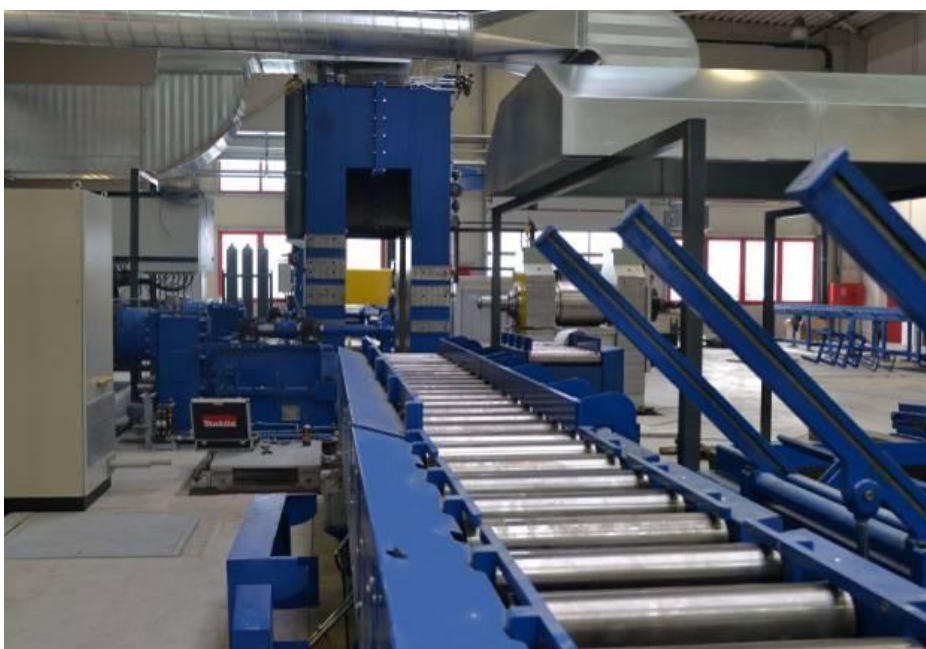
Obr.4 Válcovací stolice umožňuje válcování vyvíjených materiálů zatepla i zastudena v konfiguracích duo nebo kvarto
